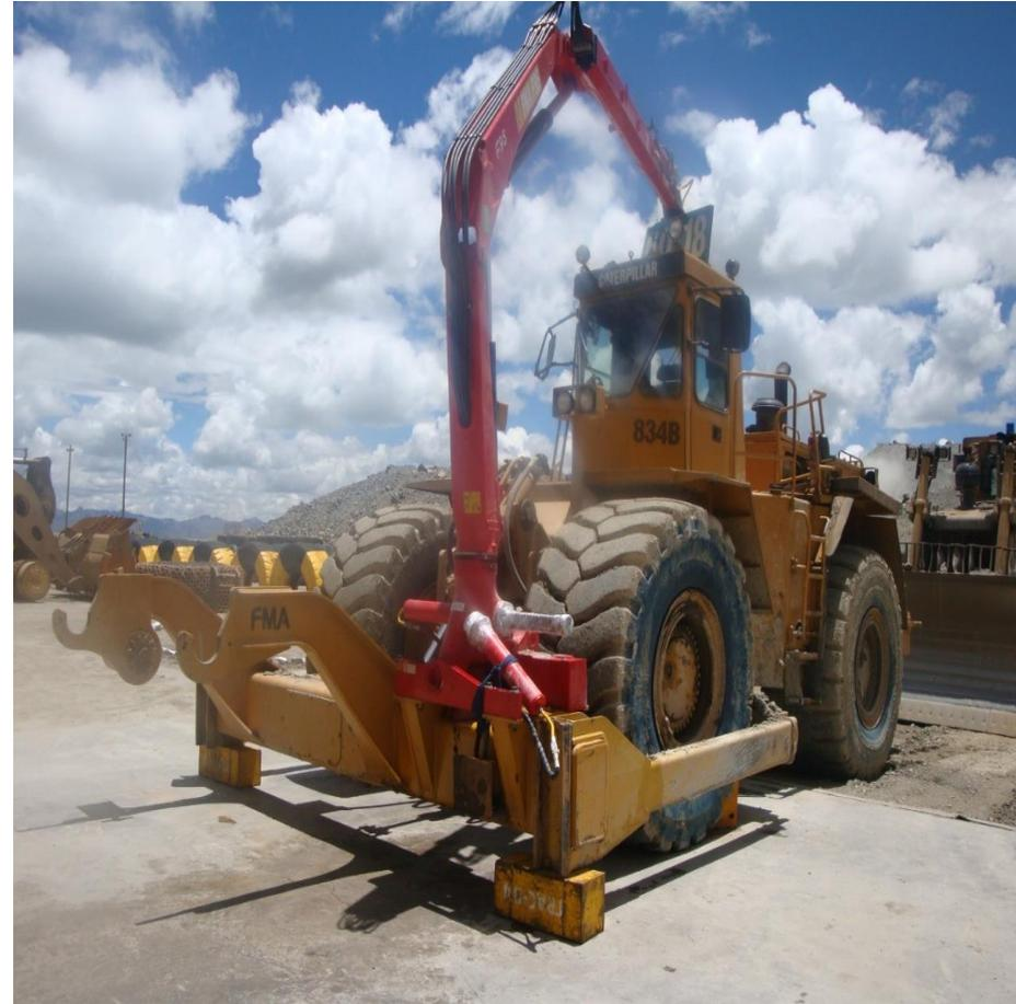
La posición del brazo con diseño rígido y de gran longitud, presentó un desplazamiento sobre la cabina producto de una operación inapropiada y atascamiento del cable eléctrico
