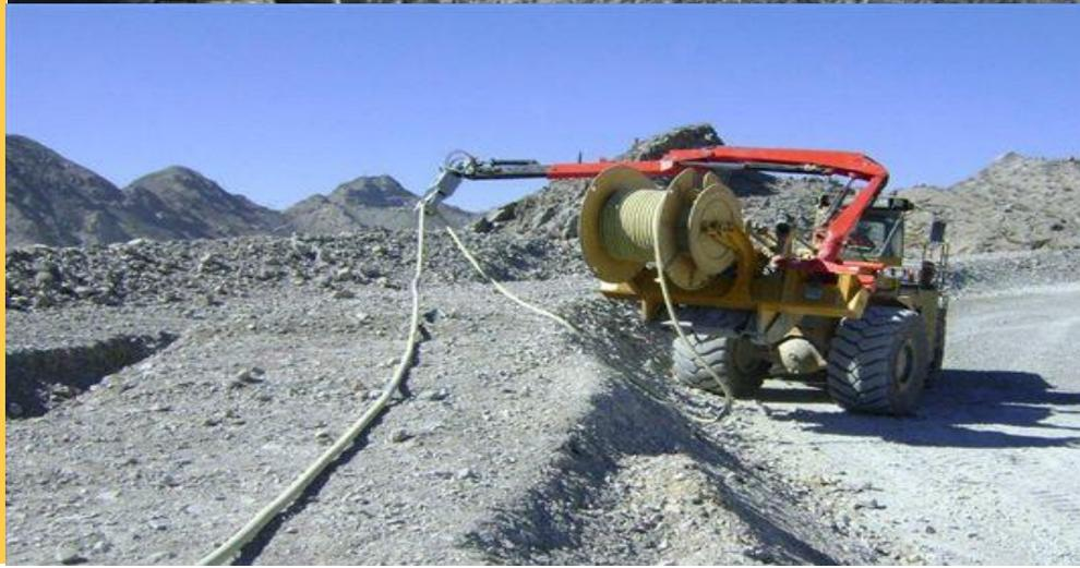
El Sistema de Giro instalado en este tipo de brazos, accionado por motores hidráulicos o cilindros sobre cremallera, presenta problemática en el giro más allá de lo esperado, producto de la configuración mecánica
